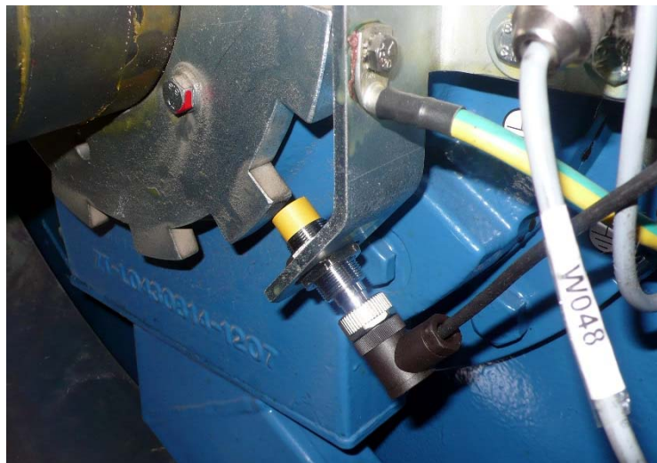
Bild 25: Drehzahlsensor radial montiert
